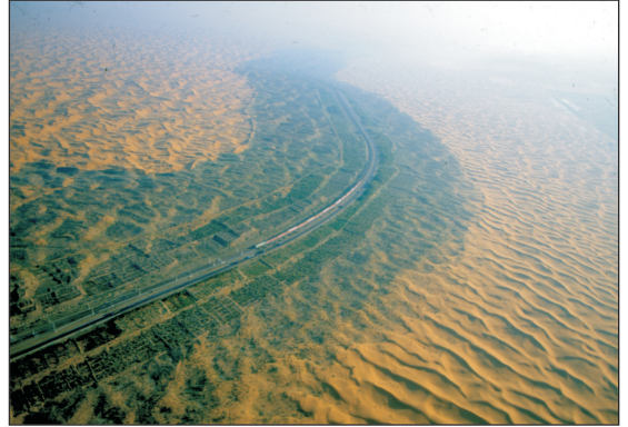
图 2 草方格固沙防护工程案例
